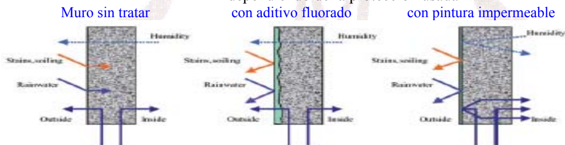
Figura 4. Diagrama que muestra el balance del agua en un muro dependiendo de la protección usada
