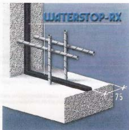
Junta horizontal y vertical de muro
